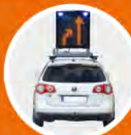
Rétrécissement de deux à une voie
